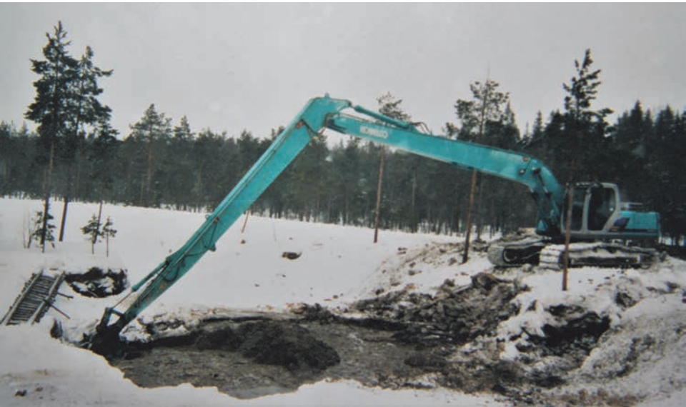
Pitkäpuominen Cobelco kaivuri oli tehokas työkonne ojien ruoppauksessa.
